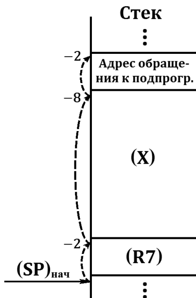
Рис. 13. Пример использования стека для хранения данных.
